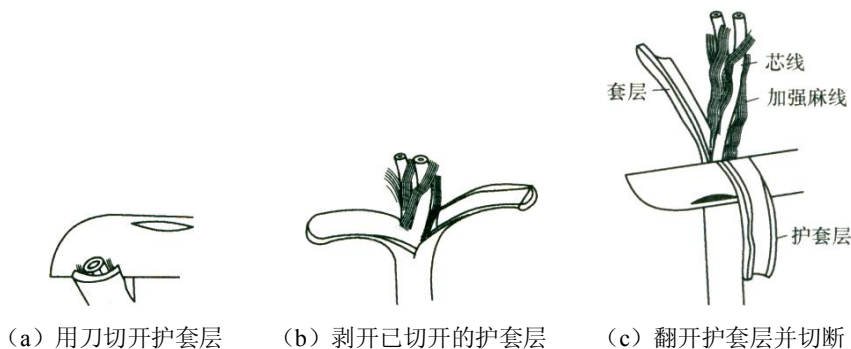
图 2-15 橡胶软电缆线的绝缘层剥削
