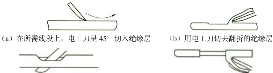
(c) 电工刀刀尖挑开绝缘层，并切断一端 (d) 用电工刀切去另一端的绝缘层
