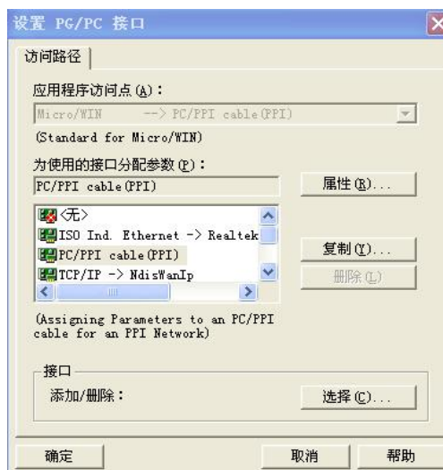
图 1-1-29 S7-200 CPU 连接站对话框
