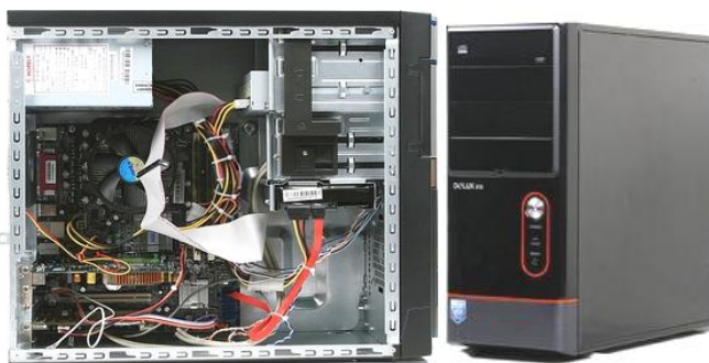
图 2-24 计算机机箱内部结构与后后面板
