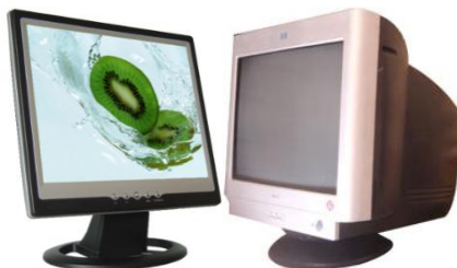
图 2-17 液晶 (LCD) 和阴极射线管 (CRT) 显示器
