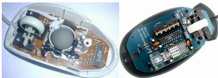
图 2-21 机械式鼠标和光电式鼠标的内部结构
