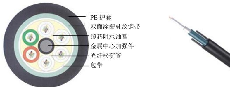
图 2-16 管道式光缆结构
