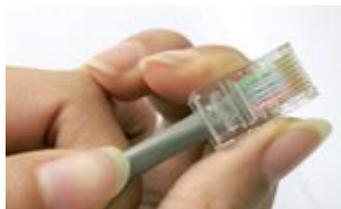
图 2-54 插入 RJ-45 水晶头
