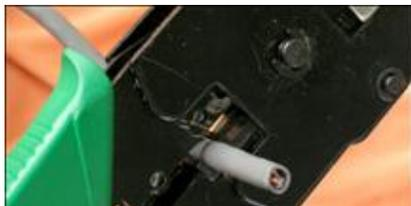
图 2-49 剥开双绞线外绝缘套
