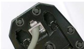
图 2-55 压接 RJ-45 水晶头
