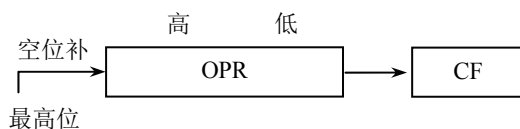
图 3-13 SAR 算术右移指令示意图
