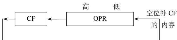
图 3-15 RCL 带进位循环左移指令示意图
