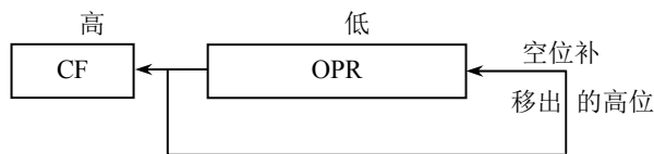
图 3-14 ROL 循环左移指令示意图
