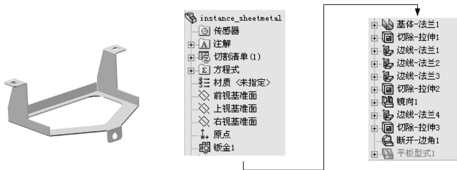
图 2.1 钣金件模型及设计树
