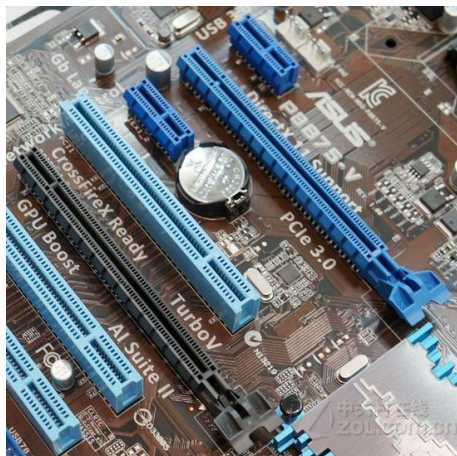
图 3-10 PCI Express16X 插槽和 1X 插槽（最短）、PCI 插槽（中等长度）
