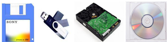
图 2-13 外部存储器：软盘、U 盘、硬盘、光盘
