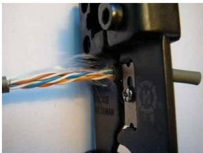
图 2-4 利用压线钳剥线
