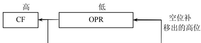
图 3-14 ROL 循环左移指令示意图
