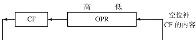
图 3-15 RCL 带进位循环左移指令示意图
