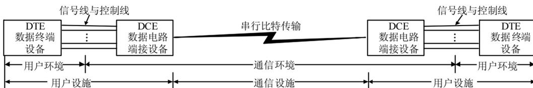
图 3-3 DTE 通过 DCE 与通信传输线路相连
