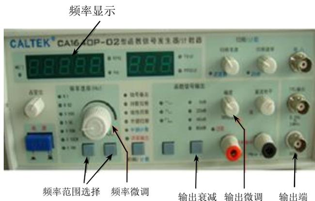
图 13-10 函数信号发生器
