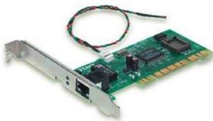
图 2-1 PCI 总线网卡
