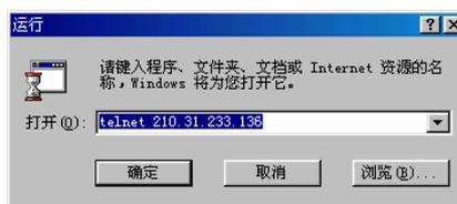
图 2-27 通过 Telnet 连接到交换机
