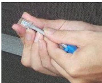
图 2-8 将线头插入 RJ-45 接头
