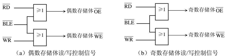
图 4.22 统一译码时读/写控制信号产生电路
