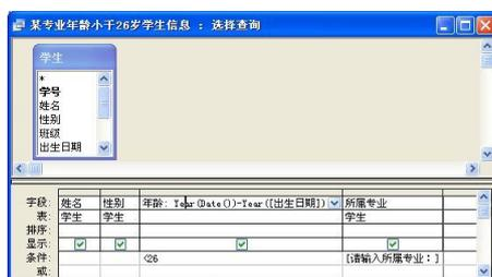
图 1-4-21 设置新字段和条件
